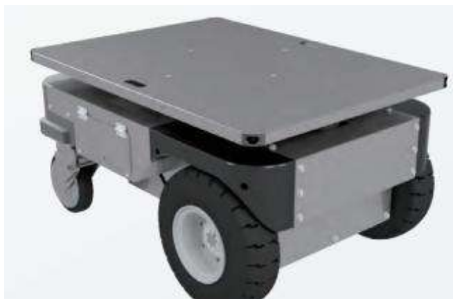
追従型の運搬支援ロボット
