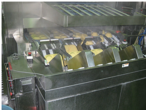
食器洗浄機 食器をかごに入れたままお湯に漬け、汚れを落とすやす くし、一枚一枚ベルトコンベアーに載せ洗浄、計数する。
