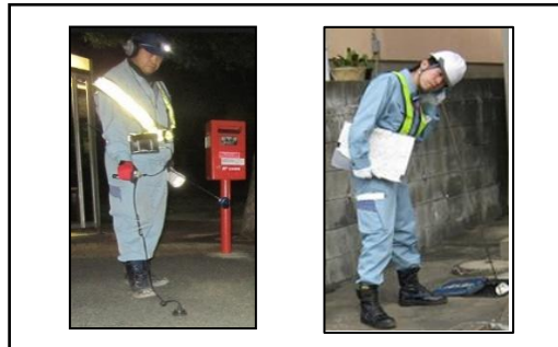
漏水探知機や音聴棒による漏水探知
