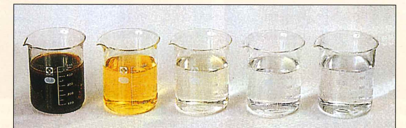
一次・二次処理水 加圧浮上分離処理水 濾過処理水 放流水 水道水
