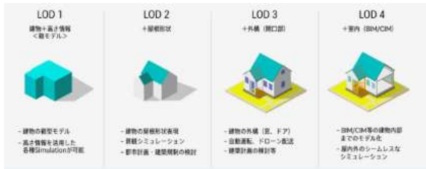
図 3-2-1 CityGML の LOD の概念 (「3D 都市モデルの導入ガイダンス」より引用)
