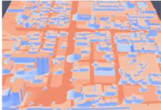
図 3-6-4 Case2 籠原南 8 時～16 時の建物の外表面温度・地表面温度分布（前頁続き）
