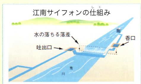
平成16年までは荒川右岸側には江南サイフォンを通じて送水を行っていました。
